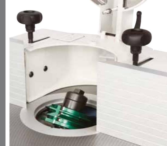
Sur demande, il est possible de commander l'option: arbre de toupie inclinable à 45° vers l'intérieur de la machine (seulement pour **st 3c** et **tw 45c**).
