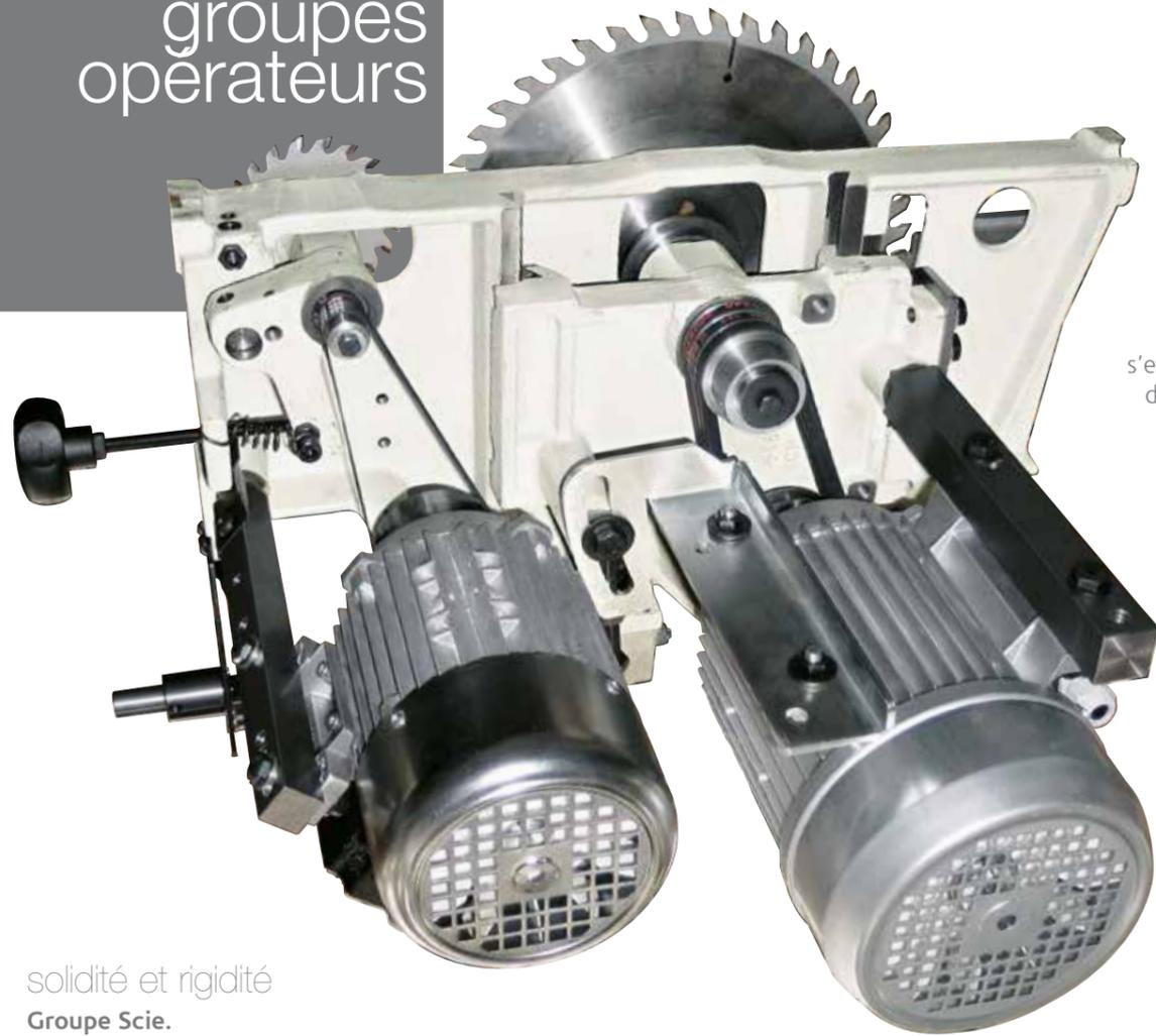
Le soulèvement du groupe lame se fait par une structure robuste en fonte avec système à queue d'aronde.
