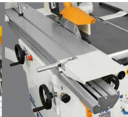
Coupes à la scie plus précises et faciles grâce à un appui parfaitement stable garanti, y compris pour les pièces de grandes dimensions, avec un **chariot coulissant de 270 mm de large.**
