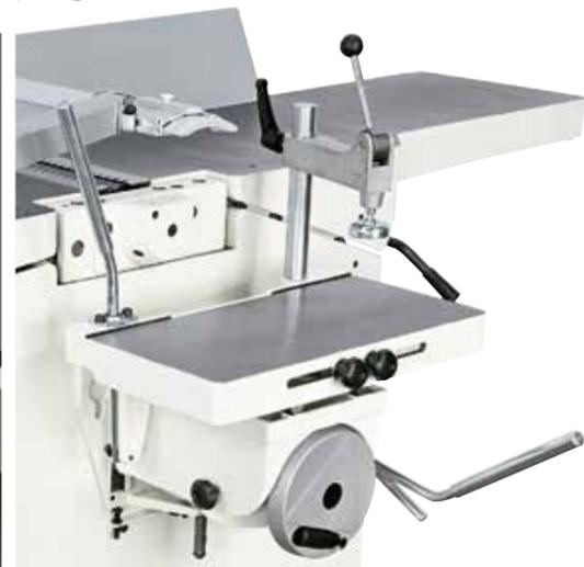
Deux vitesses d'avance au rabotage (6 - 12 m/min.) standard. Dans la **cu 410e** les tables de dégauchisseuses s'ouvrent vers l'intérieur de la machine, côté scie-toupie: une solution ergonomique et compacte.
