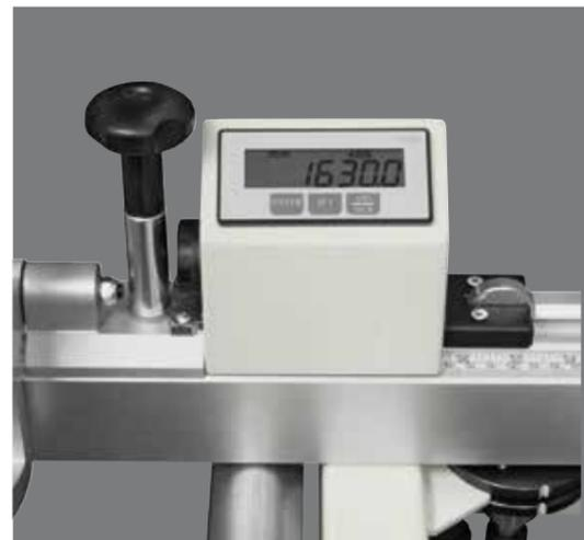
visualisateurs digitaux sur butées d'équarrissage avec réglage micrométrique.
