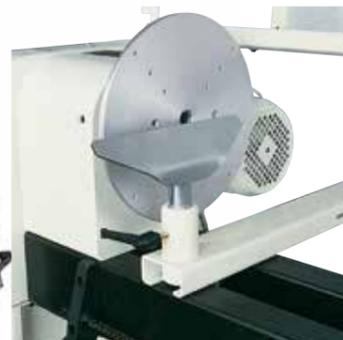
**Plateau** de diamètre 300 mm, pour réaliser de grandes coupes.
