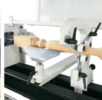
**Lunette Fixe** utilisée pour réduire les vibrations des pièces longues et fines. La forme en « C » permet le passage d'un outil.
