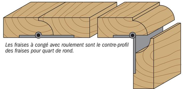
Les fraises à congé avec roulement sont le contre-profil des fraises pour quart de rond.
