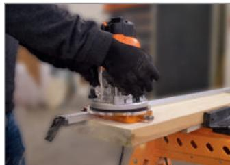
Insérer la défonceuse dans le trou central du PGD-1.
