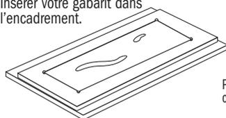
3. Plonger la mèche dans une grande partie de la rainure. Travaillez avec le mécanisme de plongée déverrouillé.
