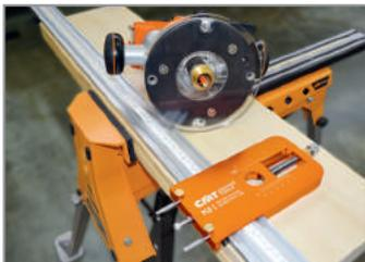
Préparer la défonceuse : Installer la bague de copiage dans la plaque pré-percée pour le CMT7E. Fixer la plaque à la base de votre défonceuse. Insérer ensuite votre fraise de préférence. Préparer la pièce de travail : Positionner l'Étau Professionnel et le PGD-1 sur votre pièce. Serrez les vis. Une fois assemblé, rassurez que le PGD-1 glisse librement le long de l'Étau Professionnel.
