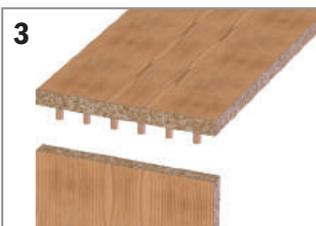
3 Insérer alors les chevilles dans les trous ainsi réalisés, en utilisant de la colle pour unir les deux éléments.
