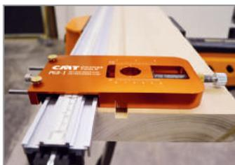
Afin de réaliser des rainures qui dépassent la dimension de la fraise, il faut simplement manipuler la vis de réglage pour l'élargissement de la rainure et choisir la largeur désirée utilisant la règle graduée.
