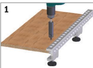
1 Placer l'outillage sur la planche, fixer le dispositif de fin de course et le serrer. Régler la profondeur du trou et serrer la mèche sur l'adaptateur porte-mèche. Réaliser les trous.
