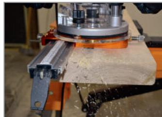
Choisir la profondeur de fraisage et déterminez le point de départ de l'usinage en utilisant les marques d'alignement du PGD-1. (12-10-8mm - côté métrique, ½.3/8"-1/4" - côté en pouces). Ces marques servent à indiquer le point de départ de la rainure et représentent la dimension (diamètre) des fraises les plus populaires.
