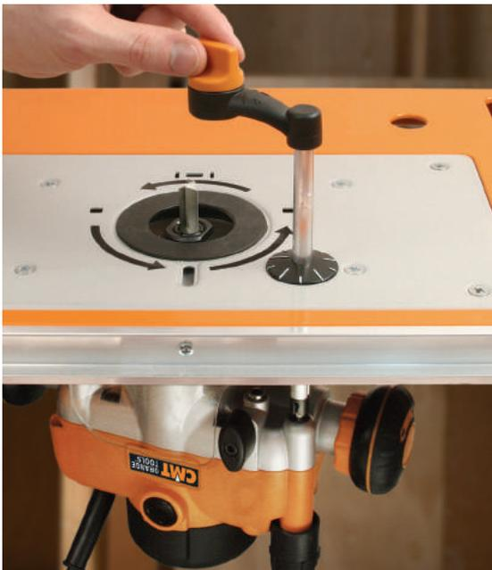
**RÉGLAGE DE LA DÉFONCEUSE**
