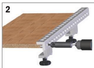
2 Serrer l'outillage sur l'autre élément, fixer le dispositif de fin de course et régler la profondeur du trou. Réaliser les trous.
