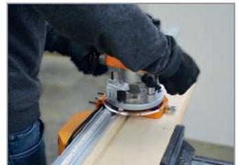
Mettez la défonceuse en position. Allumer la défonceuse. Commencer la découpe en glissant la défonceuse en avant et en arrière le long de l'étau utilisant le PGD-1 comme guide. Pour réaliser des rainures parfaitement linéaires.
