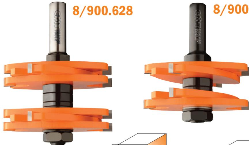
Réalisez des tenons et des mortaises parfaites avec ce jeu de fraises disques CMT ! De fait vous pourrez construire des tenons sur mesure pour vos panneaux de différentes épaisseurs. Réglez simplement la distance parmi les fraises disques avec les bagues et construisez des tenons de 4,76mm à 9,5mm d'épaisseur, jusqu'au 27mm en longueur.
